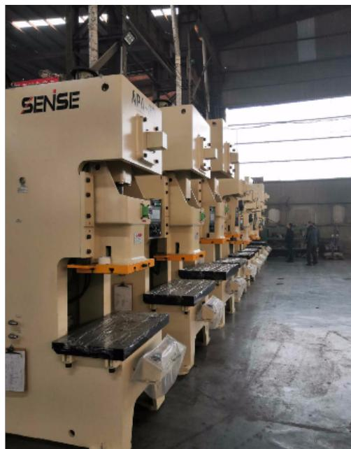
冲床在单侧裁切的全过程中，原料、模座和型腔都是造成个纵向力水准作用力，这一纵向力会造成原料晃动、齿面间娘扩大、裁切精神分析疗法堡降低等负面影响。因此在设计方案冲压模时除了结构类型要到取合理对策来避免纵向力产生的负面影响比如模座、型腔反侧压构造或设备，在选择齿面空隙时，针对单侧裁切齿面的空隙，一般取一切正常空隙的30%-50%冲床，就是一台冲压式压力机。在国民生产中，冲压工艺由于比传统机械加工来说有节约材料和能源，效率高，对操作者技术要求不高及通过各种模具应用可以做出机械加工所无法达到的产品这些优点，因而它的用途越来越普遍。
