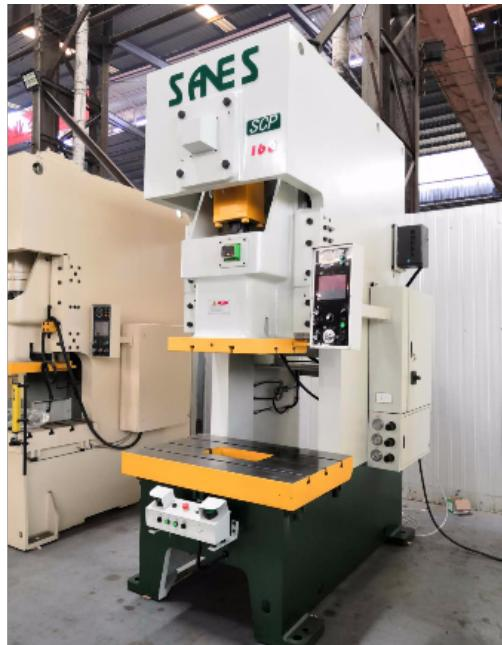
冲床根据该骨块调节设备可以临时性的调整磨具的空隙，以便捷磨具的维护保养精密冲床实际上应用时，导轨滑块调节装置的丝杆相互配合调节螺丝帽促进摇杆往上或往下晃动，在摇杆往上或往下晃动时，球座与丝杆下web端圆球部相互配合便于丝杆随摇杆小视角的晃动，避免卡住’并根据圆球部的卡掣部与蜗轮的插槽的相互配合，促使丝杆在小视角的晃动全过程中，仍能与精密冲床导轨滑块调节装置蜗轮同步旋转；摇杆往上或向下晃动的全过程中推动偏心轮在曲轴的偏心轮孔内旋转，进而根据偏心轮的轴力孔推动连接销冉冉升起或降低，以保持调整高速冲床导轨滑块高宽比的作用！
